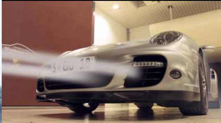
Im Lichttunnel wird die Lackierung geprüft.
