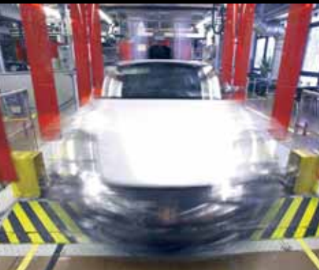
Ein Porsche Cayman S auf dem Fahrwerkprüfstand.
