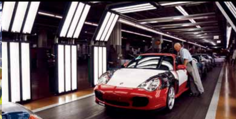
Im Lichttunnel wird die Lackierung geprüft.
